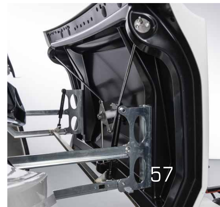
Pokrywa skrzyni na butelki może być w pełni odchylona do góry
