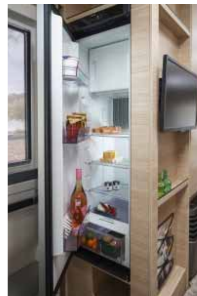
Lodówka absorpcyjna, Slim-Tower 133 l * (przy wyjmowanej komorze zamrażalnika)
