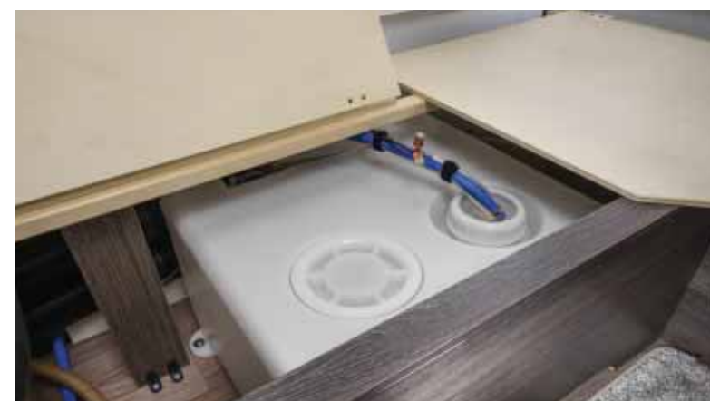
Serbatoio dell'acqua potabile con tappo del serbatoio richiudibile e troppopieno/scarico integrati
