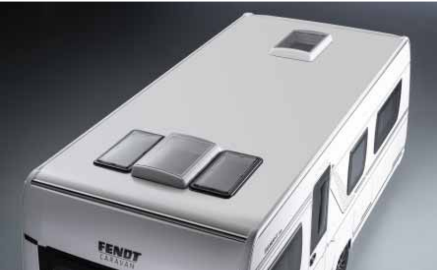
Tetto resistente in vetroresina (dotazione speciale)
