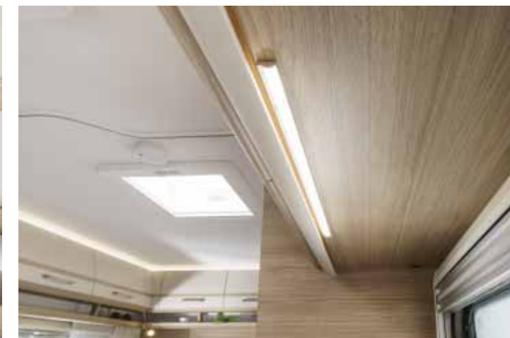
LED-Lichtleiste oberhalb der Küche *
