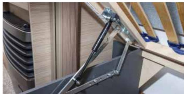
*Technique Liftomat pour une manipulation aisée à l'ouverture et fermeture de l'espace stockage sous le lit*
