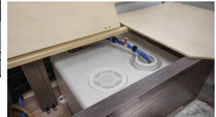
**Réservoir eau fraîche** avec couvercle verrouillable, buse de débordement/vidange intégrée
