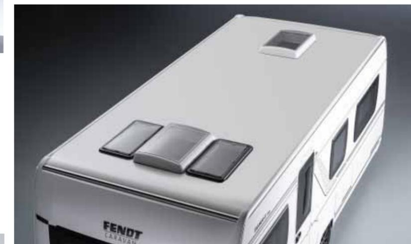
*Toiture résistante en PRV (GFK) (en option)*
