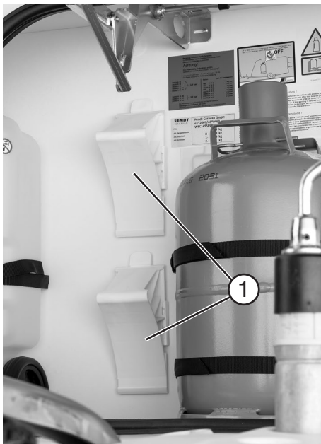
Hjulkile i gasskassen
