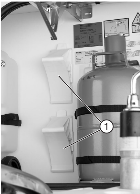
Onderlegwiggen in de gasfleskast
