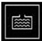
**12 Indicatore del livello di riempimento per il serbatoio dell'acqua pulita**
