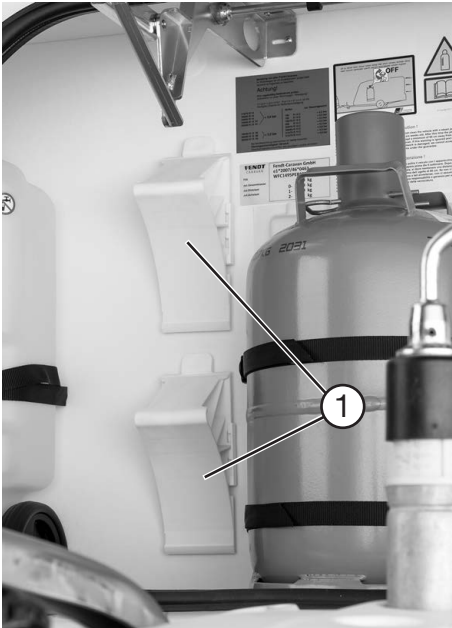
Calzos en el cofre de gas
