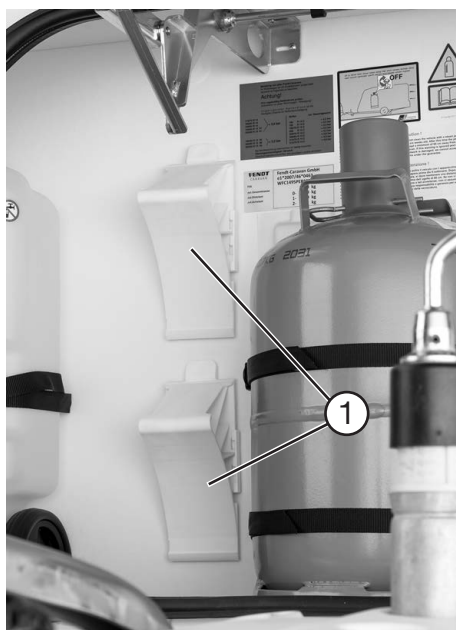
Cunei di arresto nel vano porta bombole
