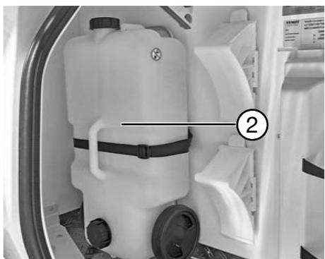
Durante la marcha, el tanque de aguas servidas ② se puede guardar en la cofre delantero para el gas a fin de ocupar un mínimo de espacio.
