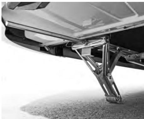
Les vérins de mise à niveau se trouvent sous la caravane à l'arrière et à l'avant.
