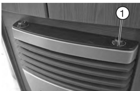
Le chauffage de votre caravane est équipé d'un système d'air pulsé à démarrage automatique. Ce système répartit l'air chaud dans tout l'habitacle. Le mode d'emploi et les fonctionnalités sont décrits dans le manuel d'utilisation « TN-3 Autostart » du fabricant TRUMA.
