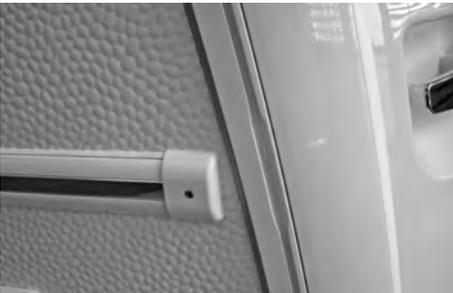
Die Vorzeltleiste ist zum Einführen des Zeltkeders am Heck / Bug in Höhe der Zierleiste aufgebördelt.
