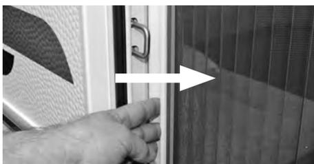
Zum Bedienen der Insektenschutztür die Griffleiste stets in der Mitte fassen und über die gesamte Breite des Türausschnitts vollständig zurückziehen, bis keine weitere Bewegung der Insektenschutztür mehr möglich ist.
