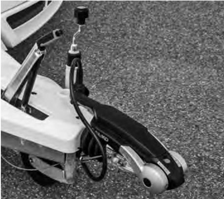
Der Caravan ist mit einer Antischlingerkupplung ausgerüstet nach ISO11555-1. Diese Sicherheitskupplung stabilisiert den Caravan während der Fahrt und sorgt damit für ein besseres Fahrverhalten.
