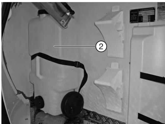
Während der Reise kann der Abwassertank ② platzsparend im Gaskasten untergebracht werden.
