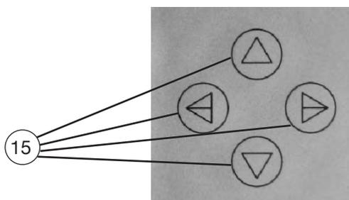
Mit den Navigationstasten (15) „Rechts“, „Links“, „Hoch“ und „Runter“ können verschiedene Anzeigen im Display aktiviert werden und es können verschiedene Einstellungen vorgenommen werden. Mit den Tasten „Rechts“ und „Links“ bewegt man sich zwischen den einzelnen Menüs. Mit den Tasten „Hoch“ und „Runter“ werden verschiedene Parameter eingestellt.
