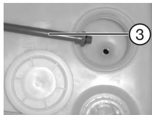
Bei Überfüllung des Tankes tritt das überschüssige Wasser mittels eines Überlaufs unter dem Fahrzeugboden aus.
