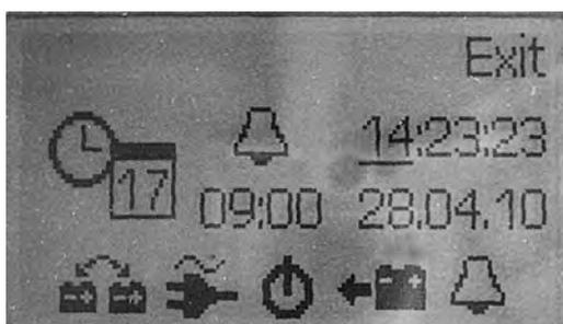
In diesem Menü bewegt man sich mit den „Rechts“ und „Links“ Tasten zu den verschiedenen Einstellwerten. Der gerade angewählte Wert wird durch die blinkende Unterstreichung des Wertes gekennzeichnet. (In dem gezeigten Beispiel die aktuelle Stunde von 14 Uhr). Mit den Tasten „Hoch“ und „Runter“ werden die Werte geändert. Betätigt man die Taste „Hoch“ oder „Runter“, wenn die Unterstreichung von „Exit“ erfolgt, wird das Menü verlassen.
