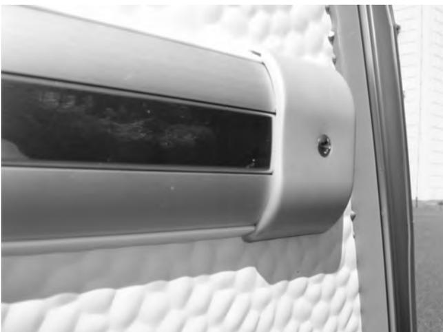
Die Vorzeltleiste ist zum Einführen des Zeltkegels am Heck / Bug in Höhe der Zierleiste aufgebördelt.
