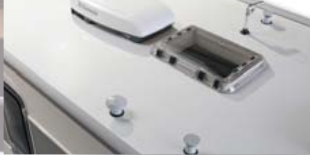
GFK-Dach mit verbessertem Hagelschutz
