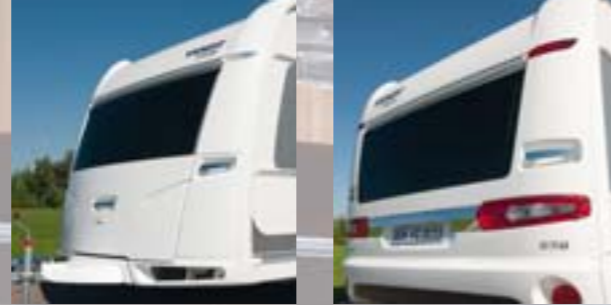
Bug und Heck im LFI-Verfahren (Verfahren zum Verarbeiten faserverstärkter Polyurethansysteme), besonders stabil und widerstandsfähig
