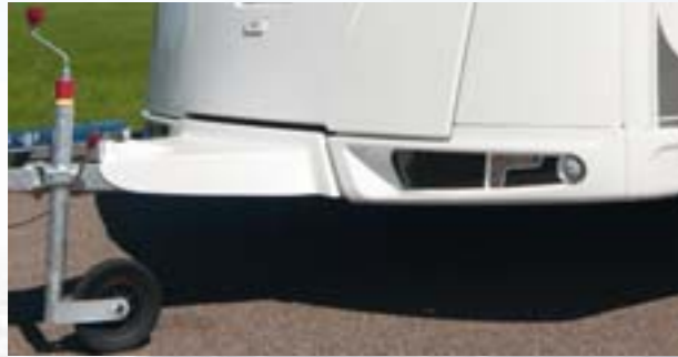
Stützrad mit harter Gummierung und Lastanzeige zur einfachen Kontrolle der Stützlast
