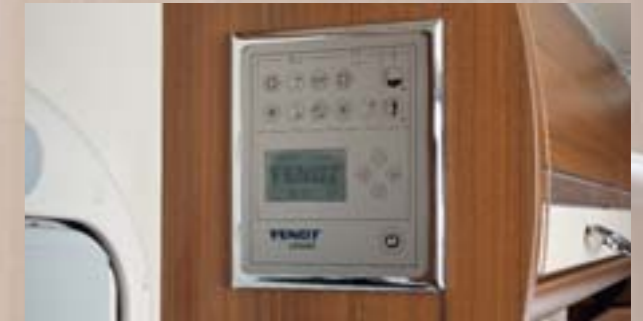
Zentrales Schaltpanel im Eingangsbereich für Licht, Wasserstandsanzeige, Zeit/Uhr, Temperatur und Fußbodentemperierung
