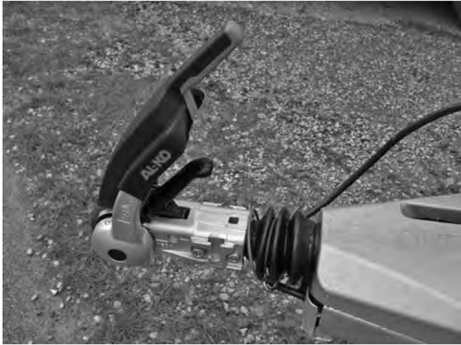
Der Caravan ist mit einer Antischlingerkupplung ausgerüstet nach ISO11555-1. Diese Sicherheitskupplung stabilisiert den Caravan während der Fahrt und sorgt damit für ein besseres Fahrverhalten.
