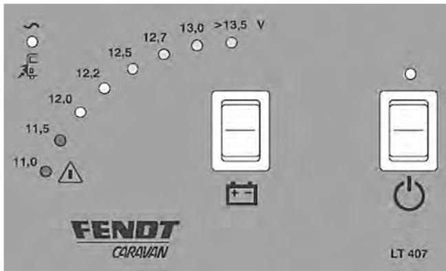
Mittels der Schalttafel können Sie den Ladezustand der Bordbatterie abfragen.
