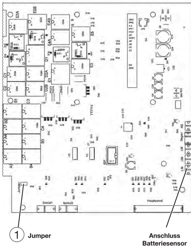
Auch beim späteren Einbau eines Autarksystems und einer Batterie im Caravan muss die Stellung des „Jumper“ ① geändert werden. Im Autarkbetrieb muss die Brücke auf den beiden Steckposten so gesteckt werden, dass diese beiden elektrisch verbunden sind. Wenn diese Umstellung erfolgt, ist es möglich im Batteriebetrieb alle Verbraucher einzuschalten.
